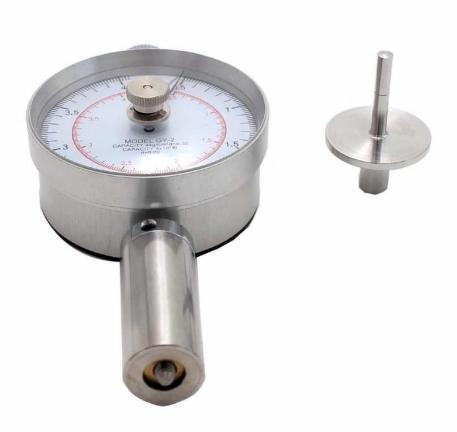
Este PENETRÓMETRO es un medidor de dureza para el control de la madurez de la fruta.
